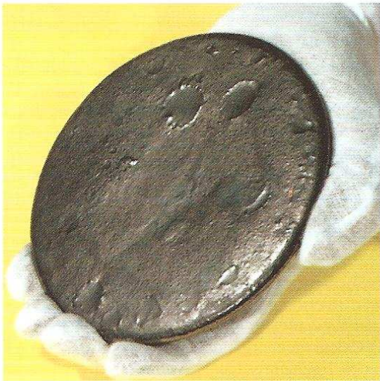
FIG. 43-14 Problema 15. Um “botão” de ^{235}\text{U} , pronto para ser refundido, usinado e incorporado a uma ogiva nuclear. (Cortesia de Martin Marietta Energy Systems/U.S. Department of Energy)
