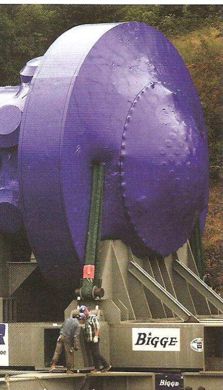
O vaso de pressão de um reator nuclear desativado, embrulhado em plástico azul, é preparado para ser transportado para o lugar onde será enterrado, na Reserva Nuclear de Hanford, perto de Richland, no estado americano de Washington. (©AP/Wide World Photos)
